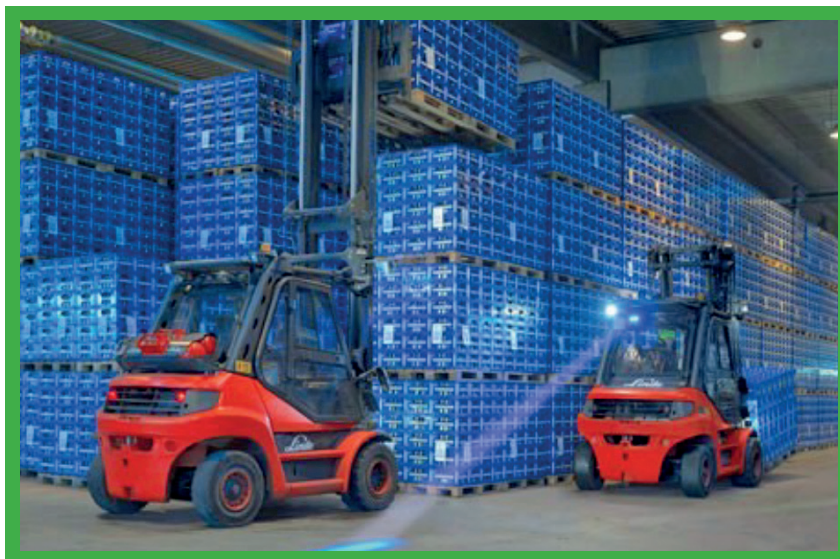
Systém modrého bodového svetla „Blue Light“ v činnosti.
