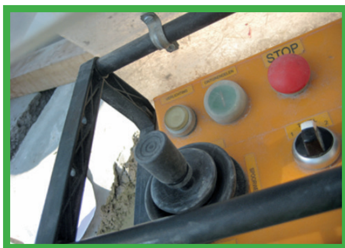
Pákový ovládač s funkciou núdzového vypnutia. Musí sa stlačiť, aby sa pákový ovládač aktivoval.
