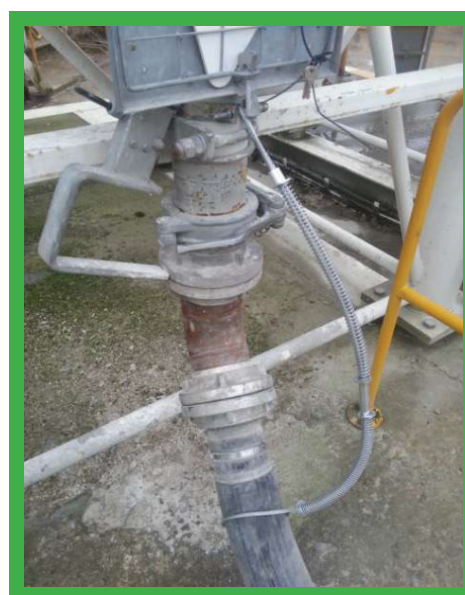
Bezpečnostný kábel na prevenciu švihu hadice v prípade jej uvoľnenia (whipcheck).
