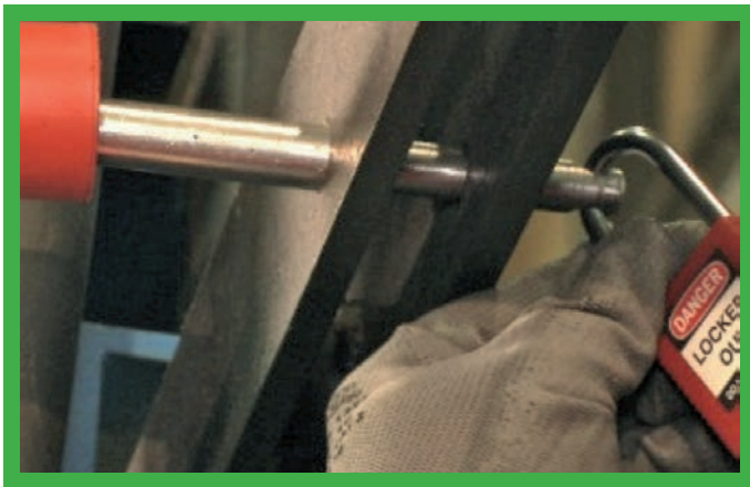
Mechanická izolácia: zaistenie posuvných dverí (Mechanická + visací zámok).
