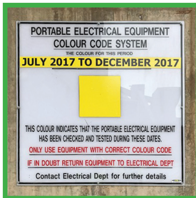
Inštrukcie pre všetkých používateľov prenosného elektrického zariadenia – používajte iba zariadenie so správnym farebným kódom štítku pre dané obdobie.
