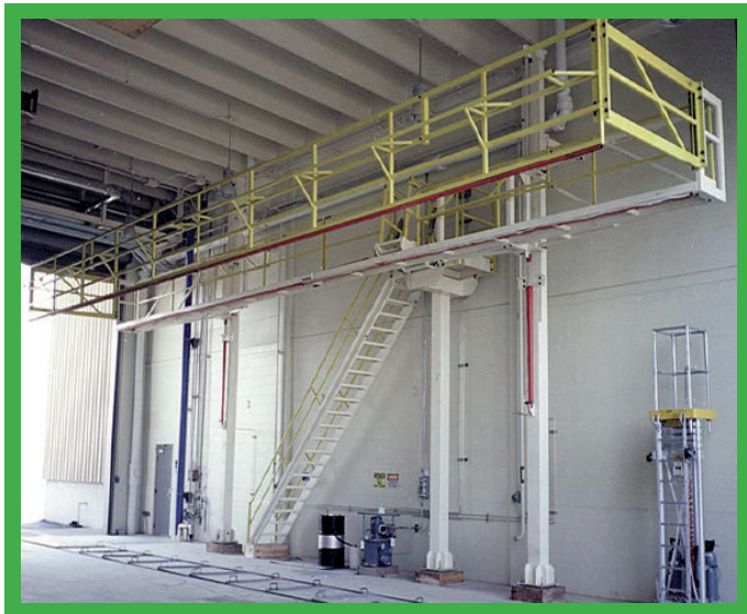
Systém v Finnsementti na ochranu vodiča cisternového vozidla počas nakladania. Tento systém sa dokáže prispôbiť čo sa týka dĺžky a výšky vozidlám všetkých rozmerov.
