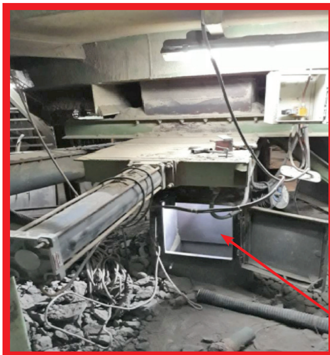
31. október 2017: Dodávateľ, vykonávajúci čistiace práce, vstúpil na potrubie, keď sa chybné otvorila pneumatiká klapa medzi potrubím a násypníkom – dodávateľ bol zavalený a utrpel smrteľné zranenia.
