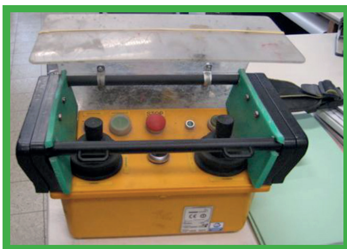
Pákový ovládač s funkciou núdzového vypnutia. Musí sa stlačiť, aby sa pákový ovládač aktivoval.
