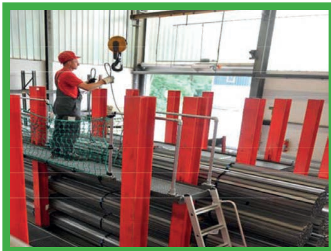
Bezpečný prístup pre pripojenie zdvíhacích hákov.
