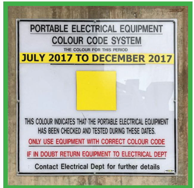
Anweisungen für alle Benutzer von tragbaren elektrischen Geräten, nur solche mit dem für diesen Zeitraum korrekten Farbcode zu verwenden.
