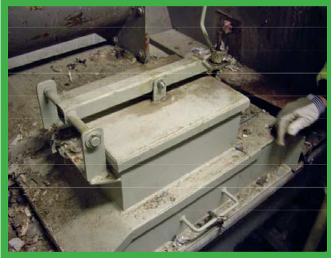
Inspektionsluke (mit Abschirmgitter) an einem Schneckenförderer.
