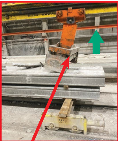
Als die Bramme in ihre Position abgesenkt war, löste der Bediener die Greifer/Klemme und hob die Klemmen weiter nach oben, um sie von der nächsten Aufgabe weg zu bewegen.
