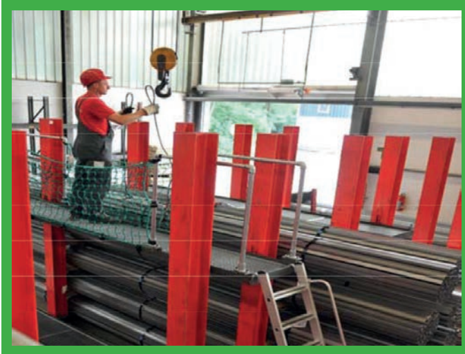
Sicherer Zugang zum Anbringen von Lasthaken.
