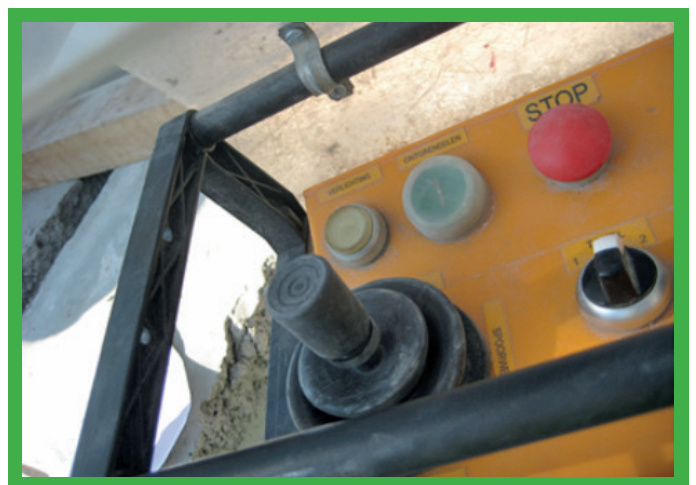
Joystick mit Totmann-Taster. Der Taster muss gedrückt gehalten werden, um den Joystick zu aktivieren.
