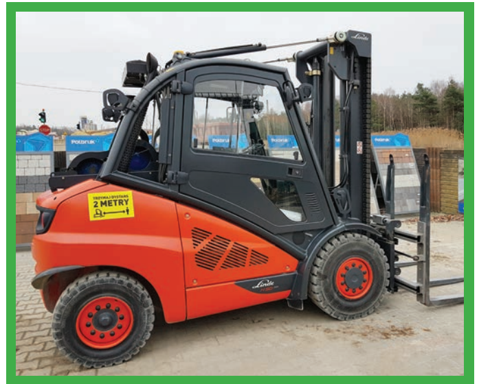
2 Meter-Regel eindeutig am Fahrzeug angebracht.
