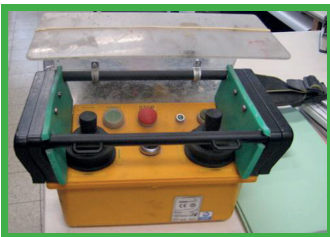
Joystick mit Totmann-Taster. Der Taster muss gedrückt gehalten werden, um den Joystick zu aktivieren.
