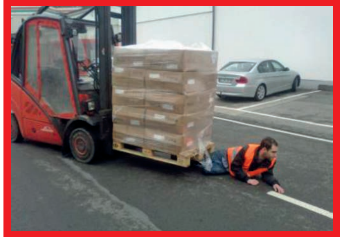
Rekonstruktion eines schweren Unfalls – März 2015: Arbeiter von vorwärts fahrenden Gabelstapler erfasst. Sicht des Fahrers war durch die Last eingeschränkt.
