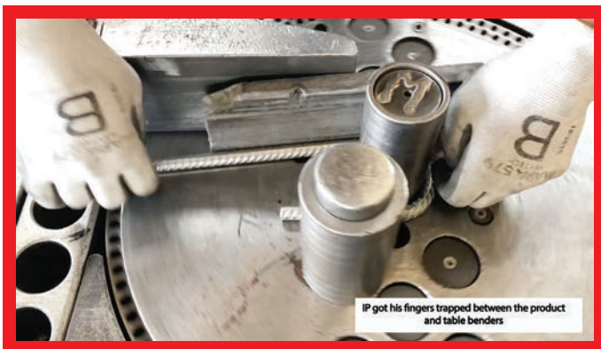
2020 Unfall mit einer Biegemaschine: Verletzte person hat seine Finger zwischen Produkt und Tischbieger eingeklemmt.
