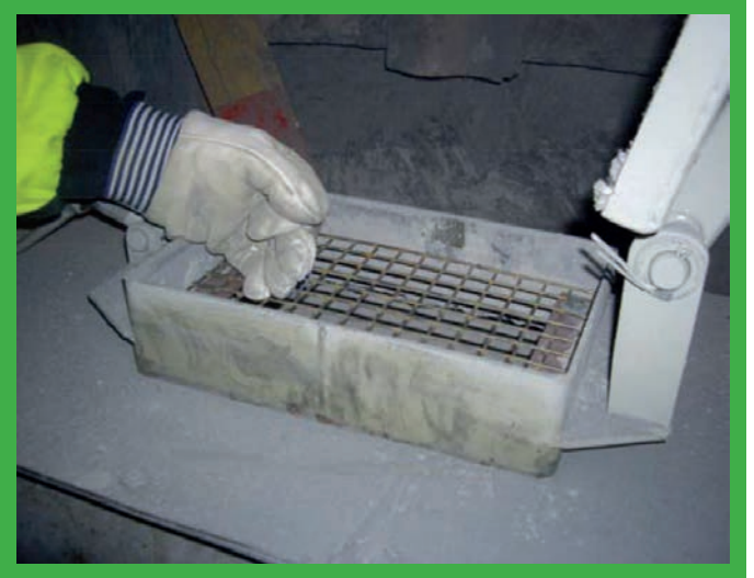
Inspektionsluke (mit Abschirmgitter) an einem Schneckenförderer.
