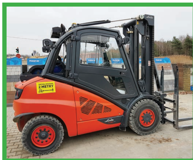
2 Meter-Regel eindeutig am Fahrzeug angebracht.
